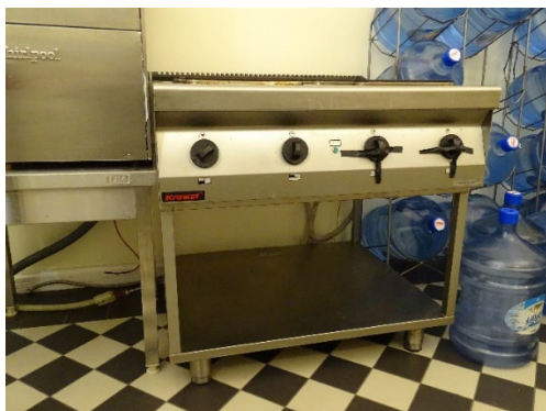
5) Kuchnia elektryczna – Kromet 16kW, rok produkcji 2016 (2 x płyta grzewcza nie grzeje)
