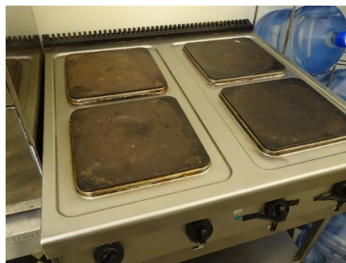
5) Kuchnia elektryczna – Kromet 16kW, rok produkcji 2016 (2 x płyta grzewcza nie grzeje)
